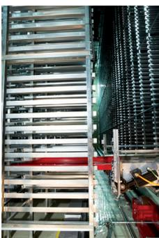
Bild 13: Der Roboterarm des Einmastbediengeräts greift nach einem der Tablare, in denen die säurefreien Kartonbehälter mit den Kunstwerken gelagert sind.
