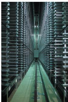
Bild 11: Einblick in die Regalschluchten des Tiefspeichers. Im Hintergrund ist eines der beiden Einmastbediengeräte zu sehen.
